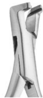
正畸钳 Distal End Cutter ZR1262RB 末端切断，镶片 用于切断过长的弓丝末端， 且能夹住剪下扎上头， 剪切扎口在0.5mm以下， 刃口镶嵌硬质合金。
