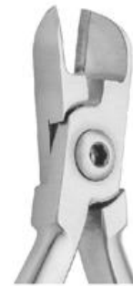
正畸钳 Ligature Cutter ZR1263RB 细丝切断，镶片 用于剪断直径0.3mm以下的 结扎丝、橡皮圈等， 刃口处镶硬质合金 (不能用来切断矫治主弓丝)。
